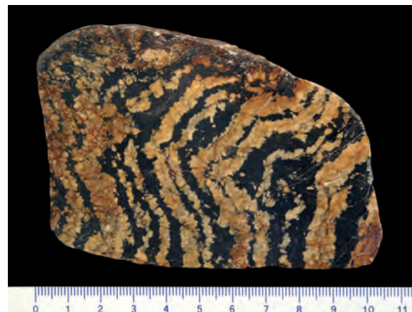
Abb. 8: Gefalteter Siderit eines Siderit-Quarz-Ganges in Wechsellagerung mit jüngerer Zinkblende der Zinkblende-Bleiglanz-Gänge (poliertes Gangstück). Grube „Füsseberg“ bei Daaden (Foto: F. Höhle).
