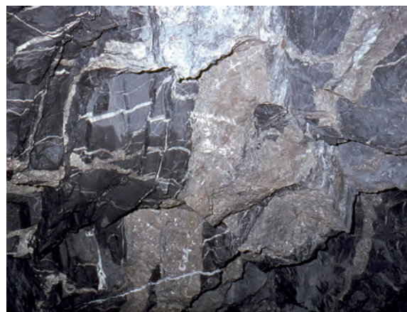
Abb. 13: Grobspätiger („spangeliger“) Siderit-Gang mit Quarztrümchen (weiß) eines Siderit-Quarz-Ganges in gebänderten Tonschiefern in der Stollenfirste. Es handelt sich hier nicht um den Hauptgang der Grube, sondern um ein Nebentrum. Deutlich zu erkennen die intensive tektonische Beanspruchung des Siderits mit Einschnürungen. Grube „Füsseberg“ bei Biersdorf, 18. Sohle, Einigkeiter Mittel, Abbau zwischen Querschlag 6 und 8 (Foto: H.-J. Lippert, 23.2.1965).
